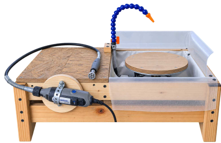
图4.4b: 旋转盘模式：转轴卸下后换上的旋转虎钳架——方形转盘轴承直接螺栓固定在架子上，两者作为一个整体移动——一块石料板固定在旋转圆盘上，潜水泵和冷却水管就在一旁。
