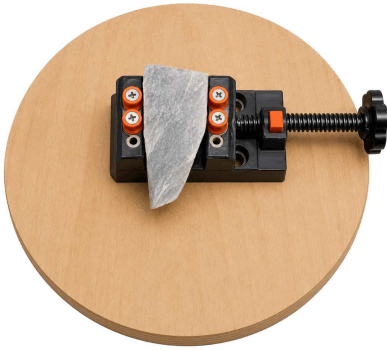
图4.5a: 旋转盘模式，小石料版本：虎钳安装在转盘上方，夹紧一块太小、没法直接用螺丝固定的石料。
