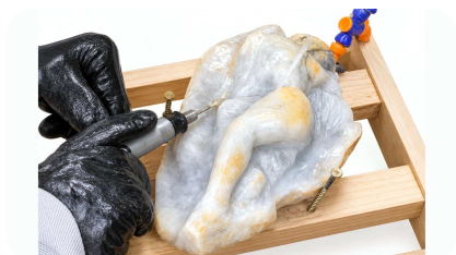
图3.7e：软轴机塑形手臂，石料湿态夹在水槽工位的夹具上。
